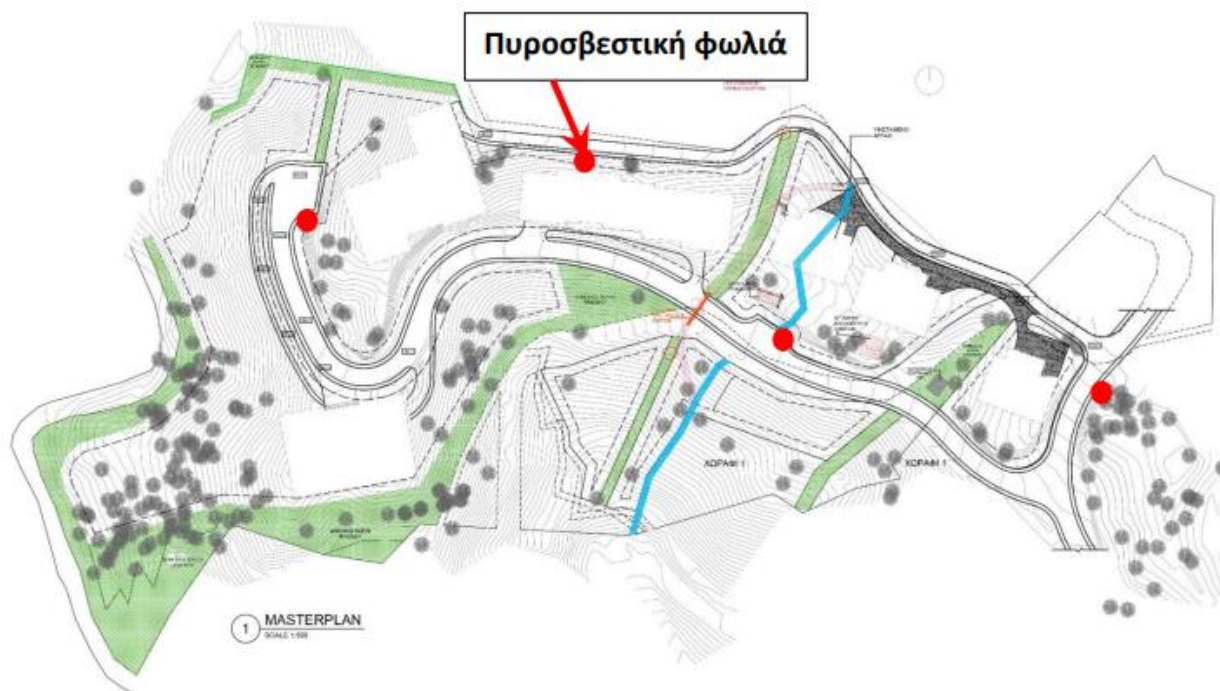
Εικόνα 4: Προτεινόμενες θέσεις πυροσβεστικών φωλιών
