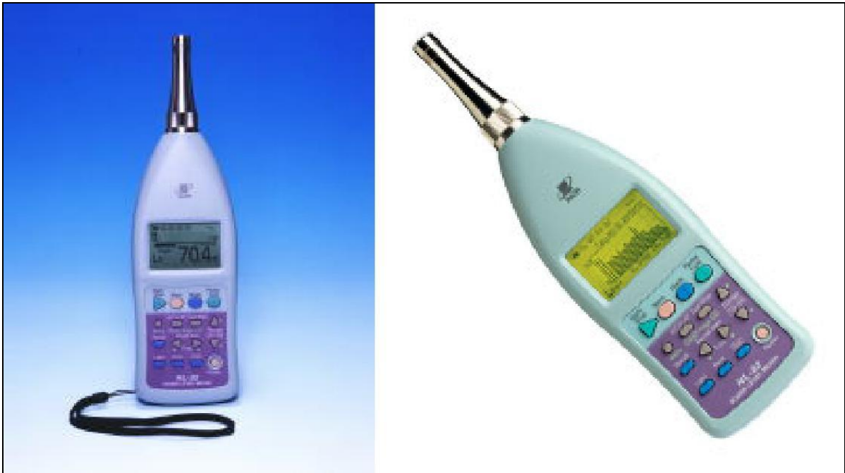
Εικόνα 8-1: Ο μετρητής θορύβου που χρησιμοποιήθηκε για τον σκοπό της μελέτης
