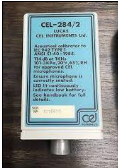
Εικόνα 8-3: Το όργανο βαθμονόμησης CEL-284/2 Acoustical Calibrator Class 1L
