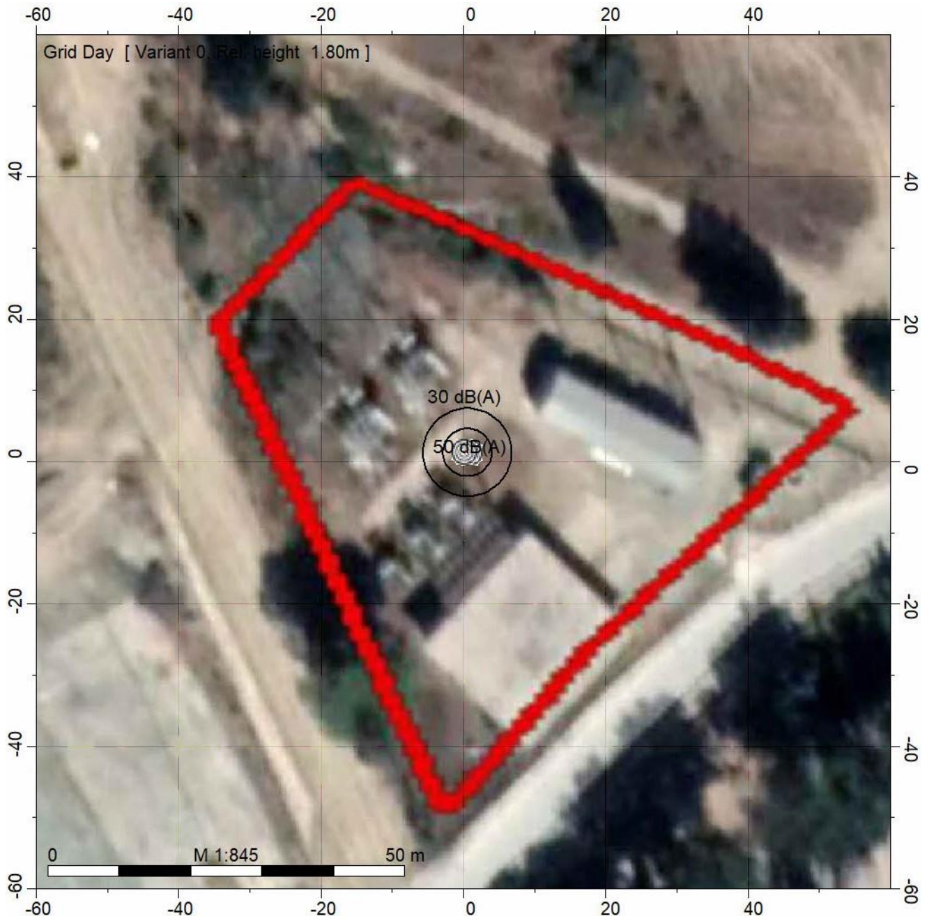
Διάγραμμα 1: Αποτελέσματα λογισμικού IMMI για τα επίπεδα θορύβου που θα εκπέμπονται από τους μετασχηματιστές στην περιοχή του έργου
