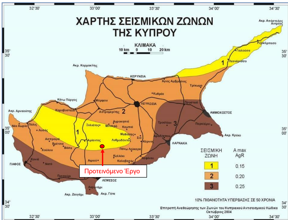
Εικόνα 9: Σεισμικές Ζώνες της Κύπρου σε κατά προσέγγιση σχέση με το προτεινόμενο Έργο.
