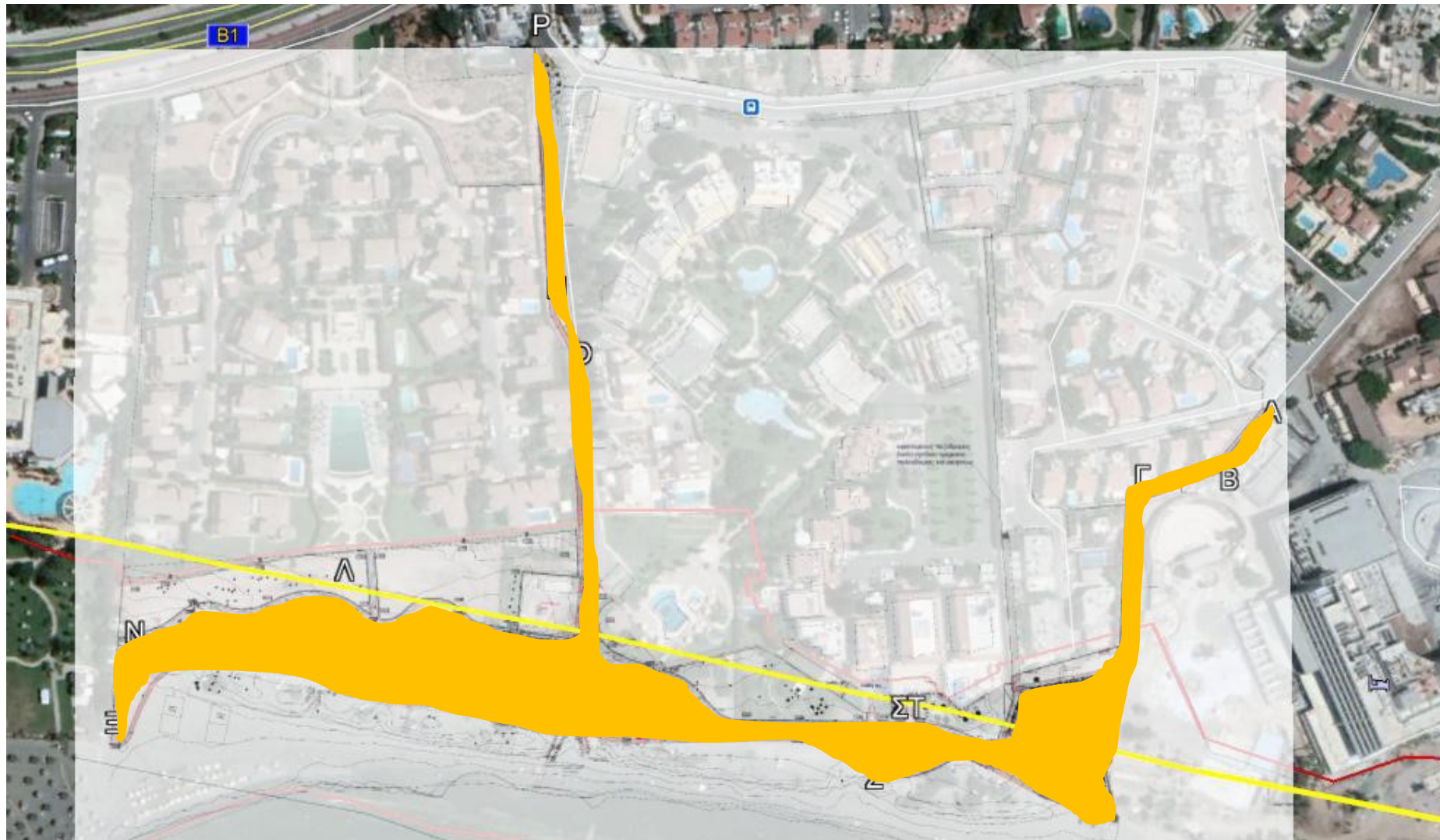
Σχήμα 6.5: Πιθανές θέσεις διαρροών από τα μηχανήματα κατασκευής
