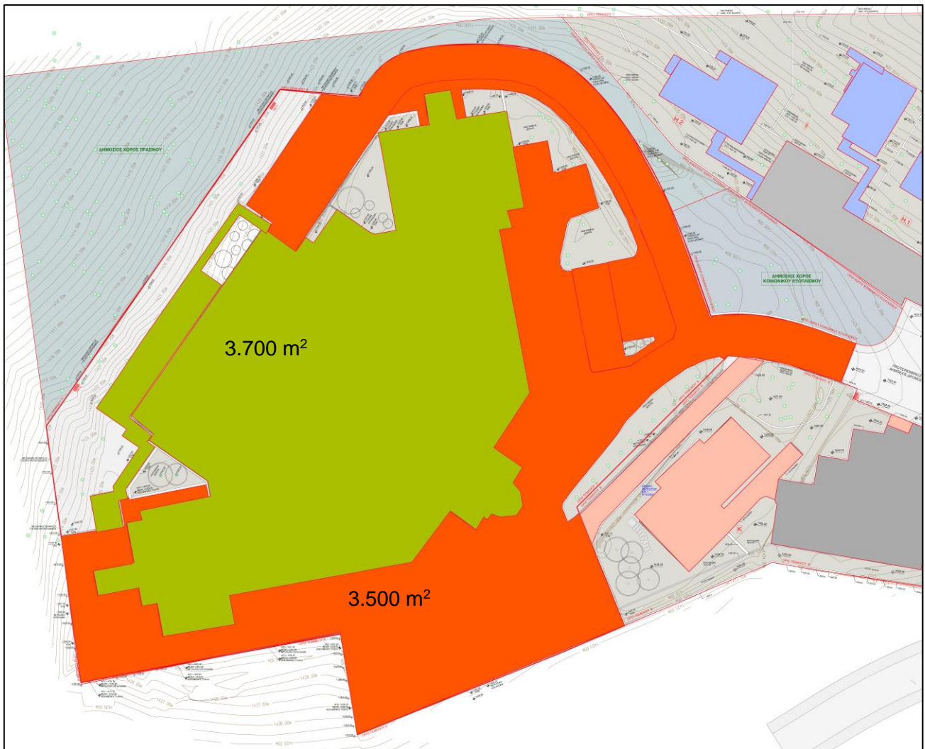
Εικόνα 3.11: Η σφράγιση που προκύπτει από το ξενοδοχείο και του άλλους καλυμμένους χώρους
