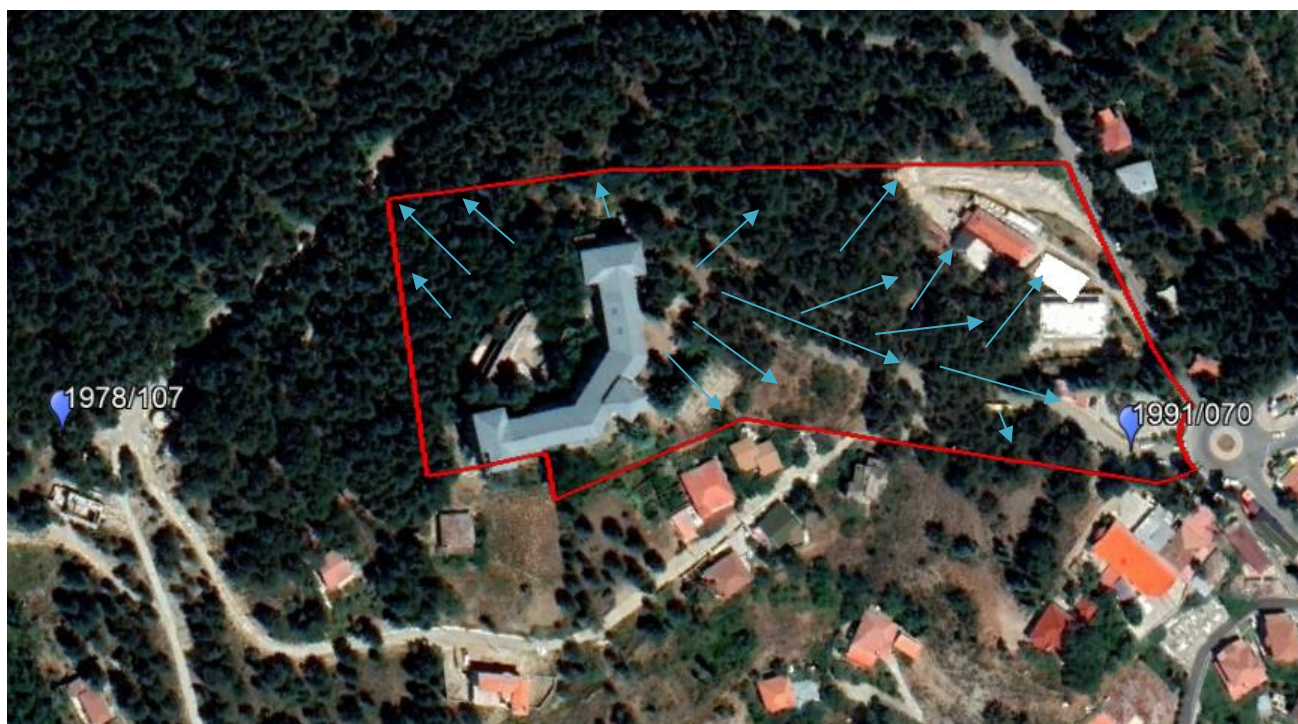
Εικόνα 5.1: Οι δύο γεωτρήσεις (μπλε σημεία) σε σχέση με το τεμάχιο μελέτης (κόκκινο πλαίσιο) και οι κλήσεις του τεμαχίου.
