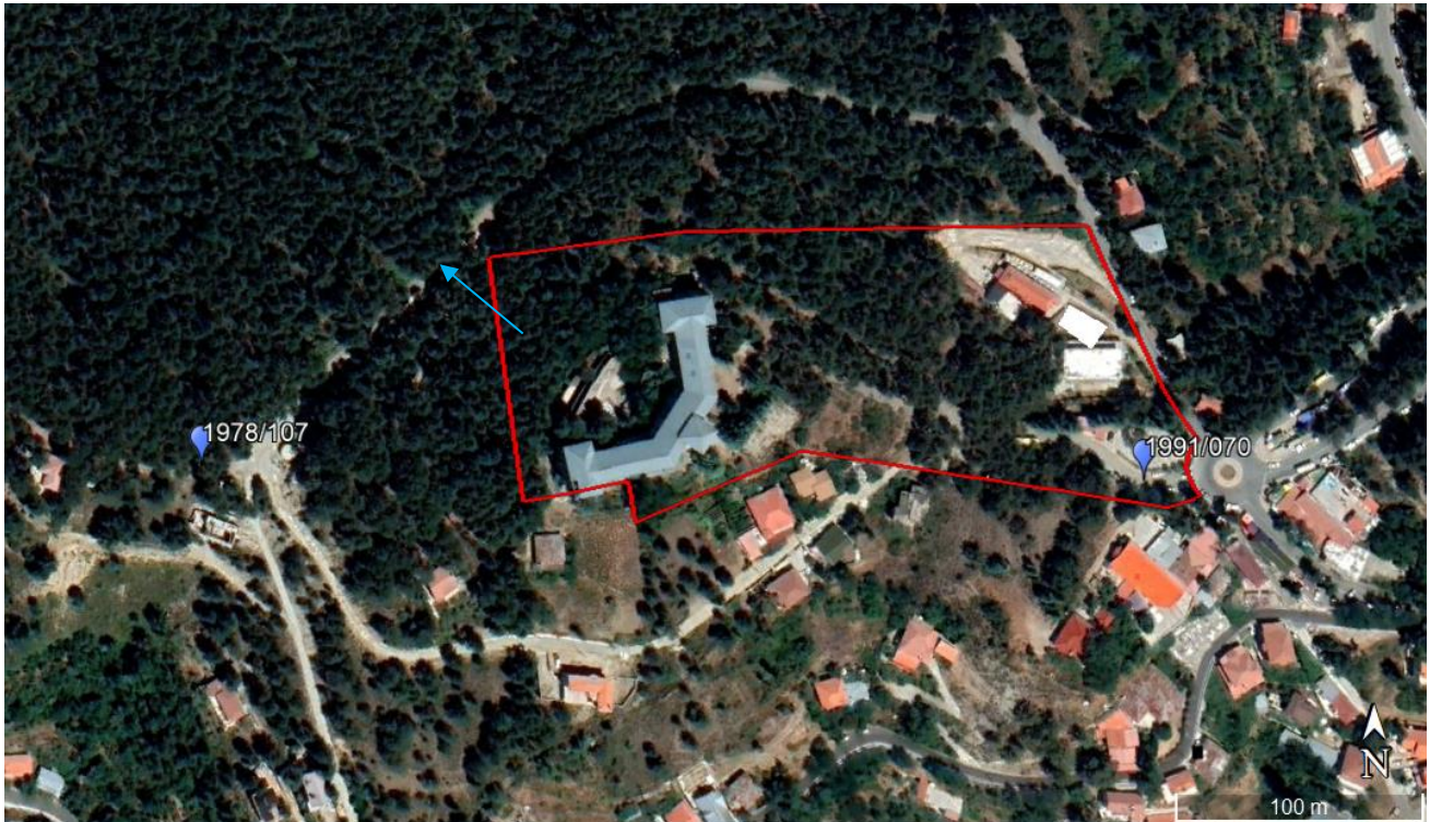
Εικόνα 3.4: Οι δύο γεωτρήσεις (μπλε σημεία) σε σχέση με το τεμάχιο μελέτης (κόκκινο πλαίσιο).
