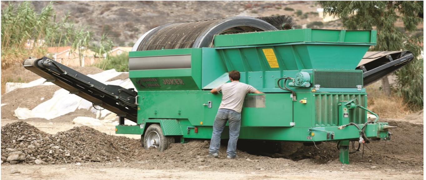
Compost Hellas Μηχάνημα διαλογής κομπόστ (TROMMEL SCREENER) Αυστριακού οίκου KOMPTTECK FARWICK
