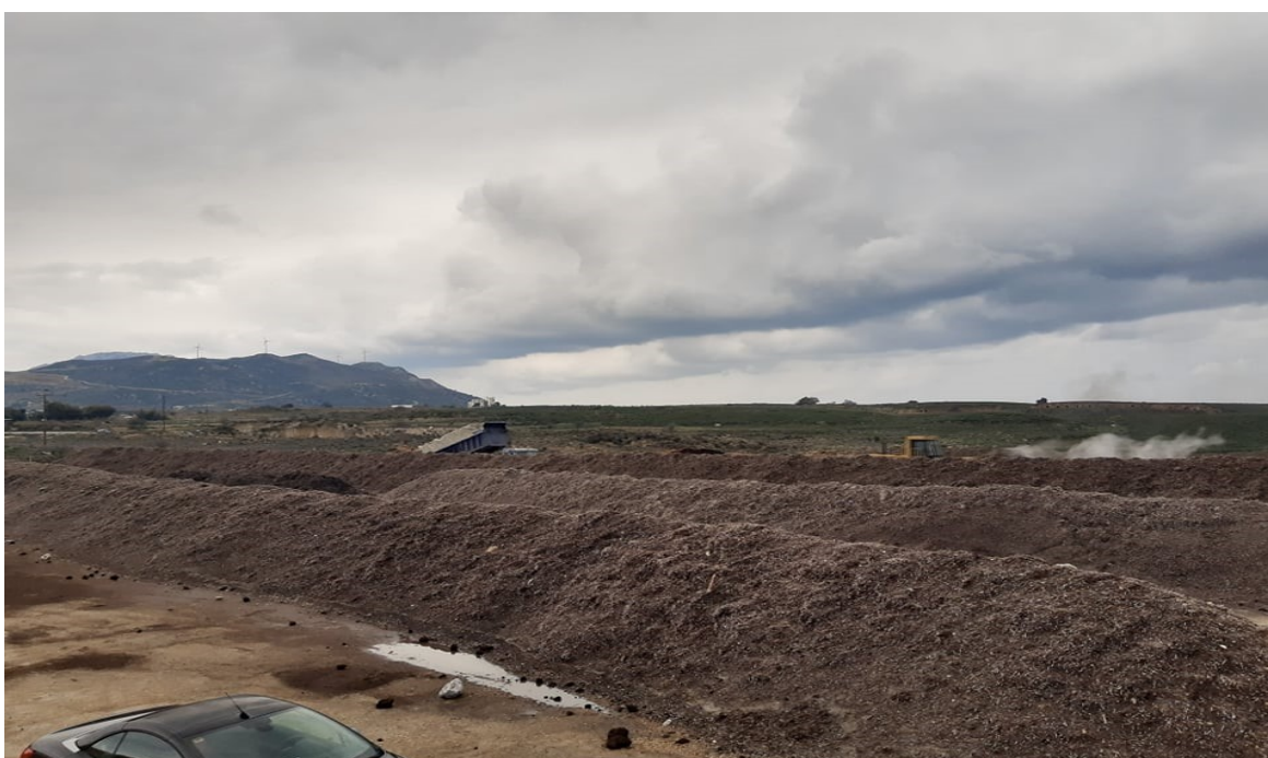
Α' στάδιο: Σειράδια (windrows)αερόβιας ζύμωσης, θερμοφιλη φάση(έως 60° βαθμούς Κελσίου)
