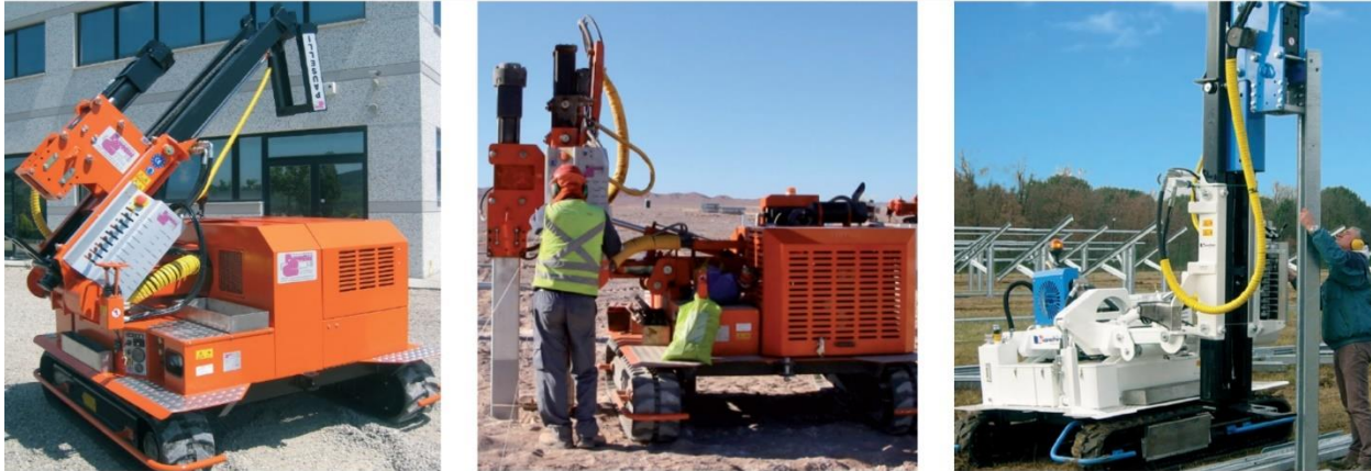
Εικόνα 17 : Μηχάνημα διάτρησης εδάφους και πασσαλόμπτυξης (ramming machine)
