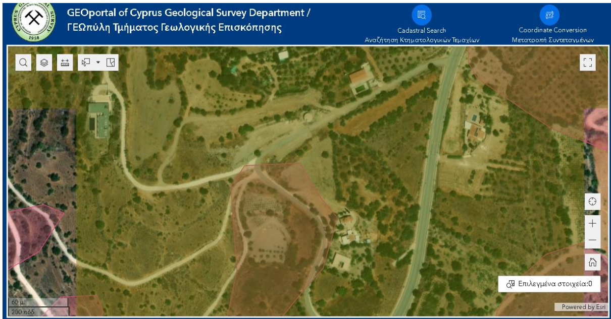
Σχήμα 13: Χάρτης Ζωνών Γεωλογικής Καταλληλότητας και Κατολισθήσεων, με κόκκινο χρώμα παρουσιάζονται τα τμήματα με ευαισθησία στις κατολισθήσεις
