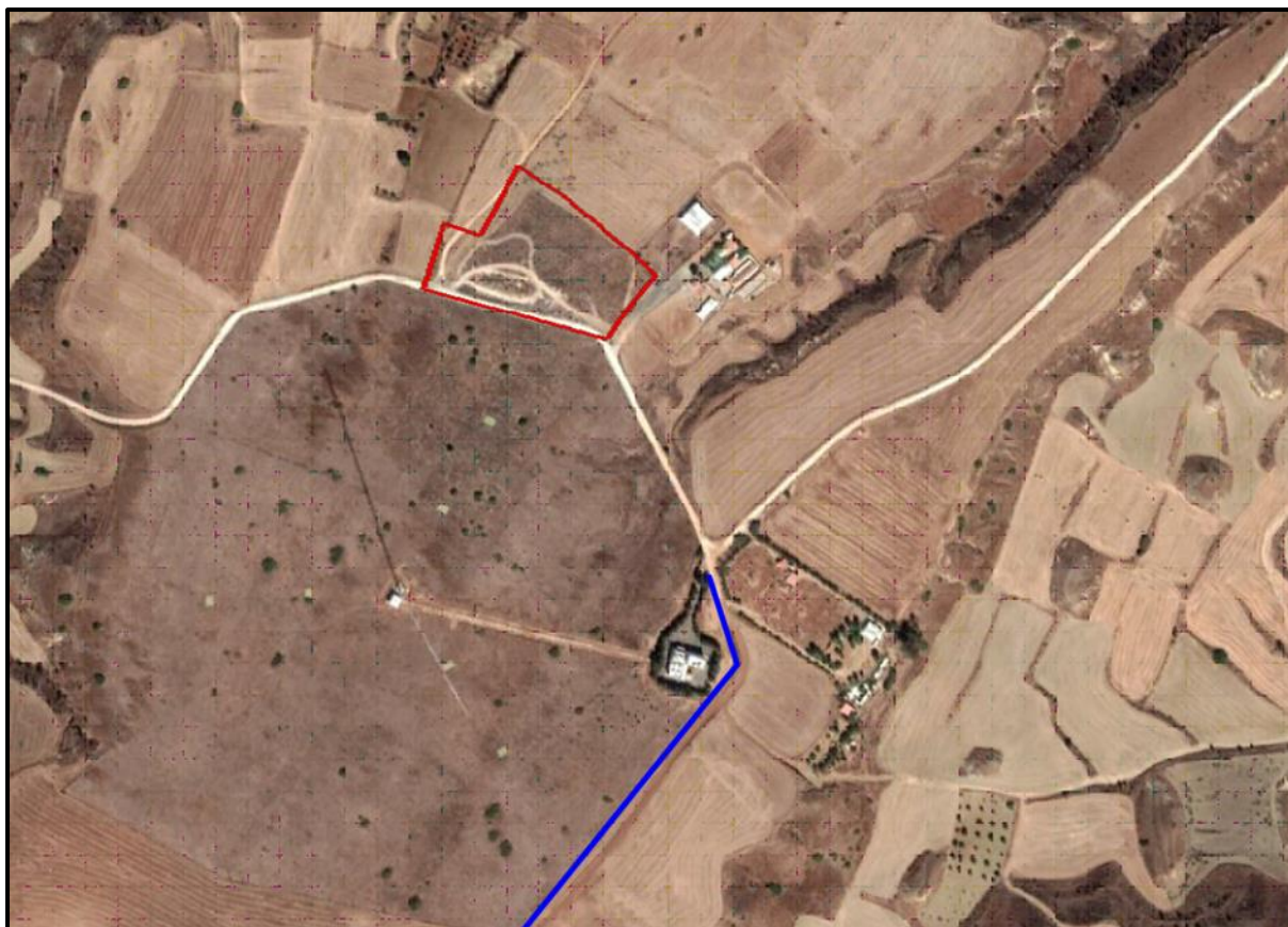
Παράρτημα 13: Περιοχή ενδιαφέροντος και Υφιστάμενο Δίκτυο 11/22kV ΑΗΚ. Με κόκκινο είναι το εναέριο Δίκτυο 11/22kV. Ο προτεινόμενος χώρος εγκατάστασης του Φ/Β πάρκου φαίνεται στη Δορυφορική εικόνα εντός των ορίων των τεμαχίων με μπλε χρώμα.
