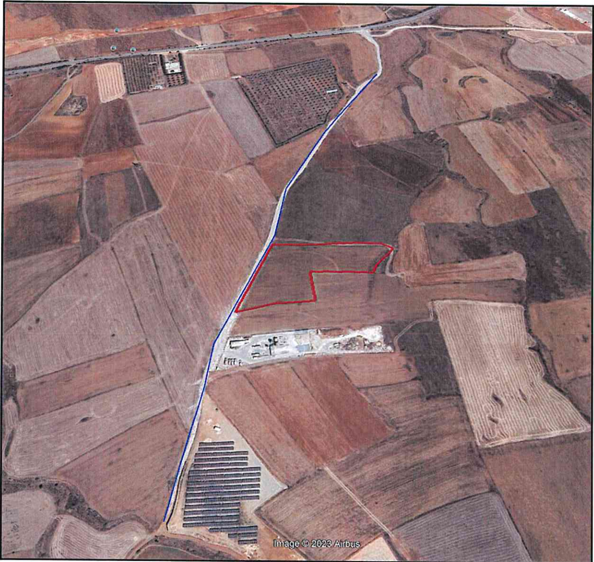
Παράρτημα 13: Περιοχή ενδιαφέροντος και Δίκτυο 22kV ΔΣΔ/ΑΗΚ. Με μπλε είναι το υφιστάμενο Δίκτυο Μέσης Τάσης 22kV και το προτεινόμενο σημείο σύνδεσης του Φ/Β Πάρκου. Ο προτεινόμενος χώρος εγκατάστασης του Φ/Β πάρκου φαίνεται στο κέντρο της Δορυφορικής εικόνας εντός του κόκκινου πολυγώνου.
