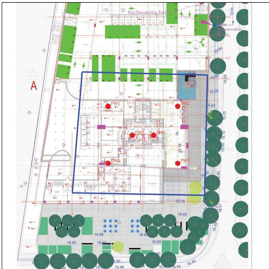
Σχέδιο 1: Θέσεις φρεατίων άντλησης υπόγειου νερού
