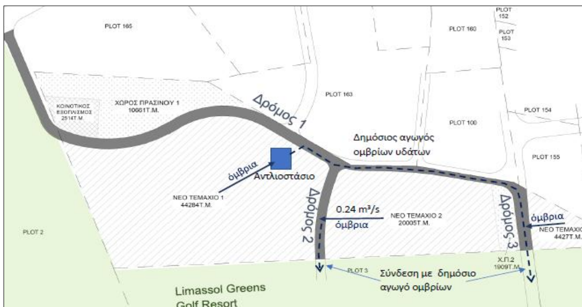
Εικόνα 2 : Διαχείριση ομβρίων υδάτων εντός και μέχρι τα όρια της ανάπτυξης
