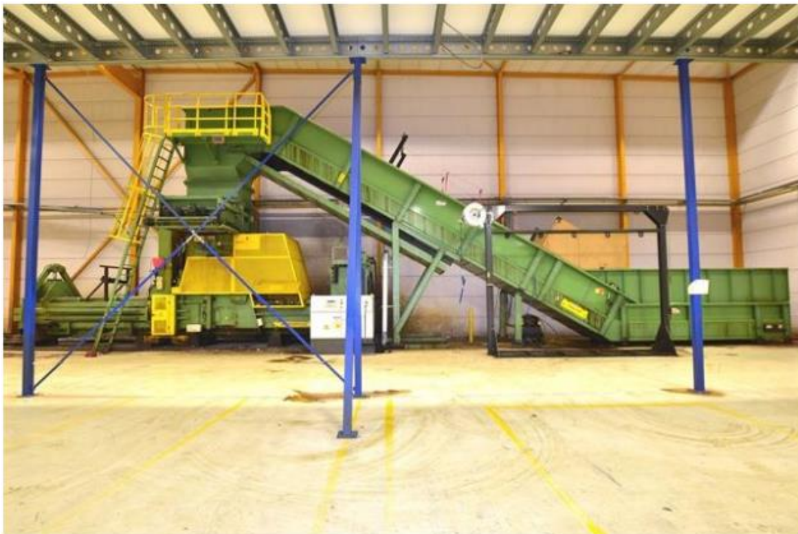
Μικρή εγκατάσταση χειροδιαλογής που ενδέχεται να εγκατασταθεί για την προδιαλογή/ καθάρισμα των εισερχομένων υλικών
