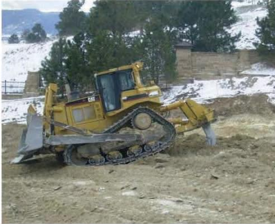
Φρέζα προσαρμοσμένη στο πίσω μέρος μπολντόζας
