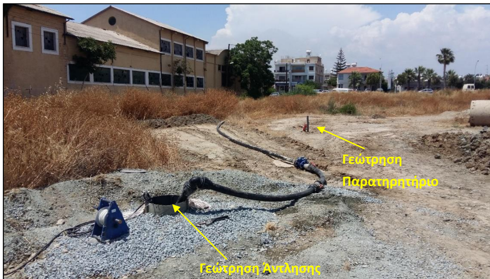
Φωτογραφία 4: Διαμόρφωση της 1 ης Δοκιμαστικής Άντλησης στην περιοχή Α2
