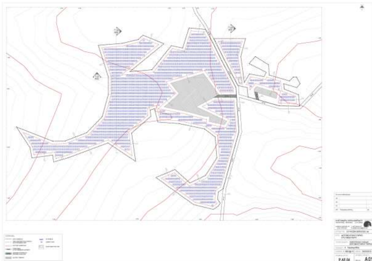
Εικόνα 3.2: Ανάπτυξη ΦΒ Πάρκου (Πηγή: ΑΕΟΛΙΚΗ Ltd.)
