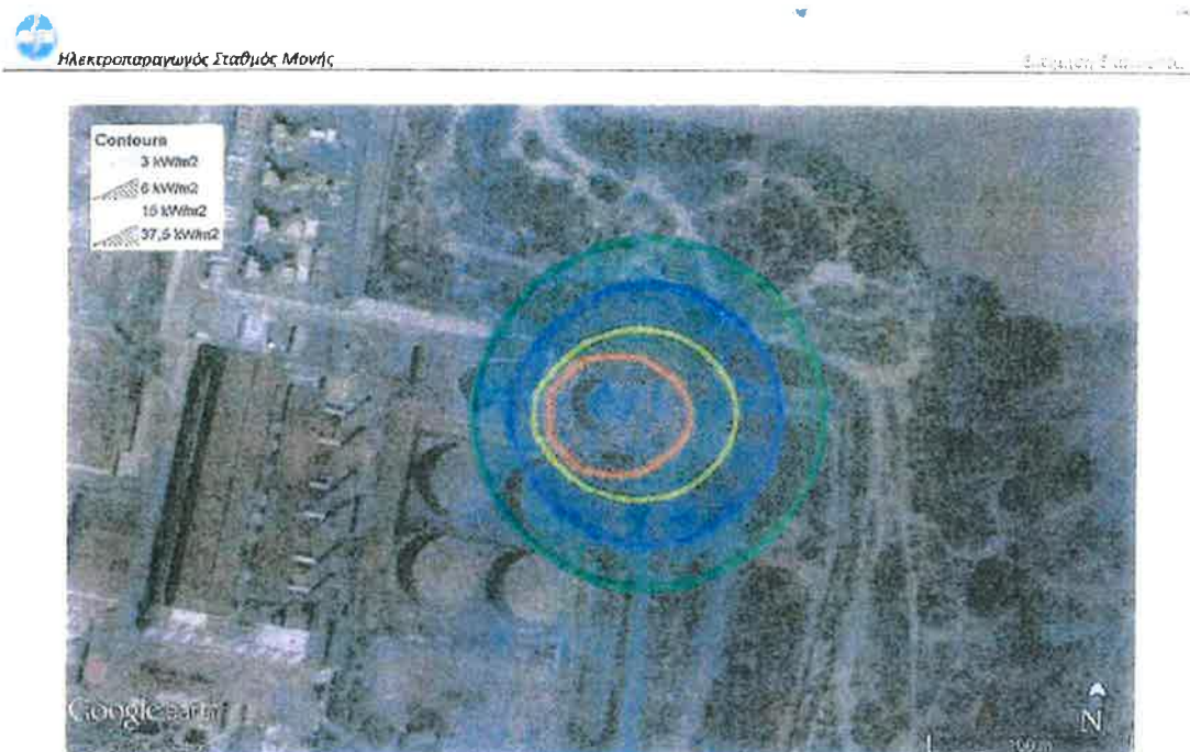
Εικόνα 6.3. Γραφική αποτύπωση των ζωνών επικινδυνότητας λόγω θερμικής ακτινοβολίας σε περίπτωση καταστροφικής θραύσης της μεγαλύτερης δεξαμενής πετρελαίου Τ3 (στο επίπεδο του εδάφους της λεκάνης)
