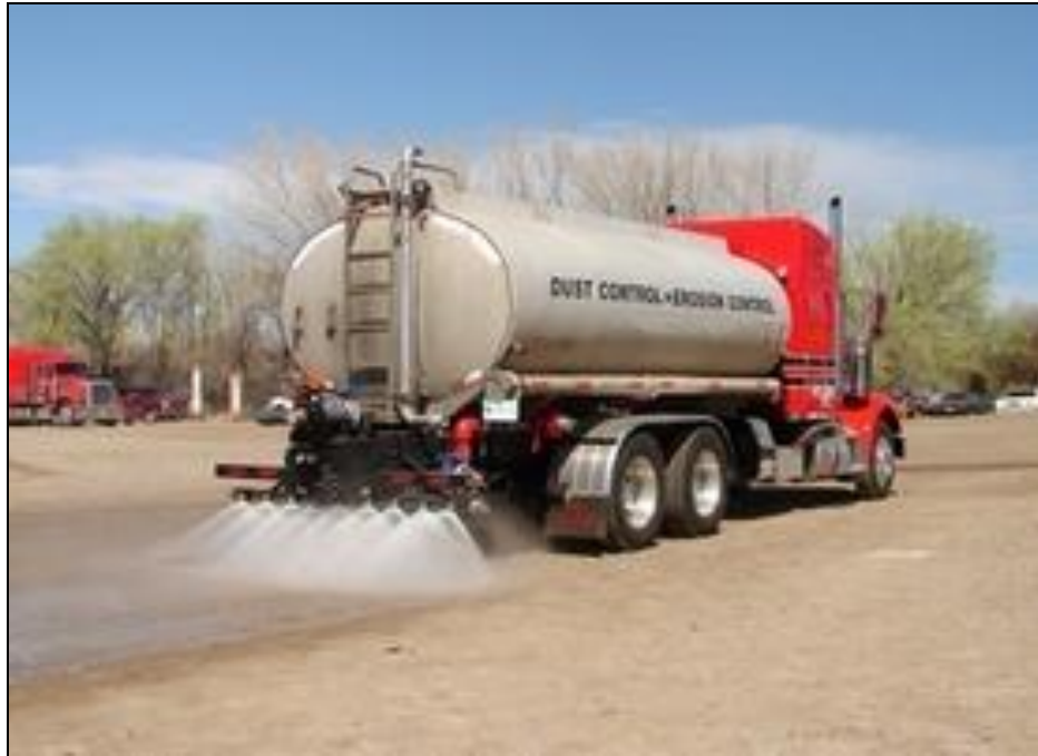
Εικόνα 8-1: Βυτιοφόρο όχημα με ψεκαστήρες για διαβροχή χωμάτων οδών
