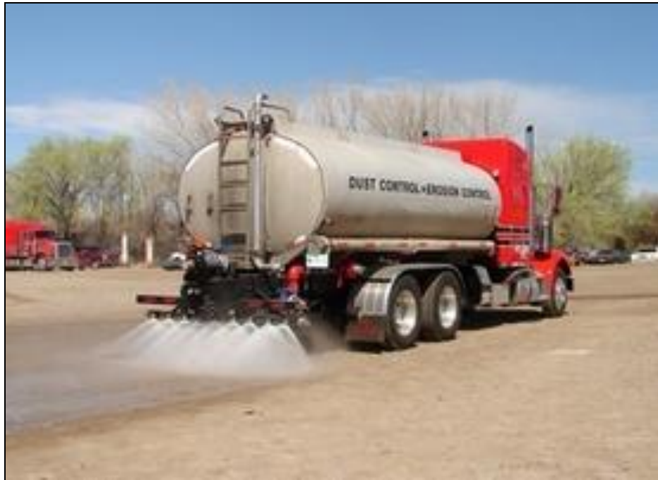
Εικόνα 8-1: Βυτιοφόρο όχημα με ψεκαστήρες για διαβροχή χωμάτινων οδών
