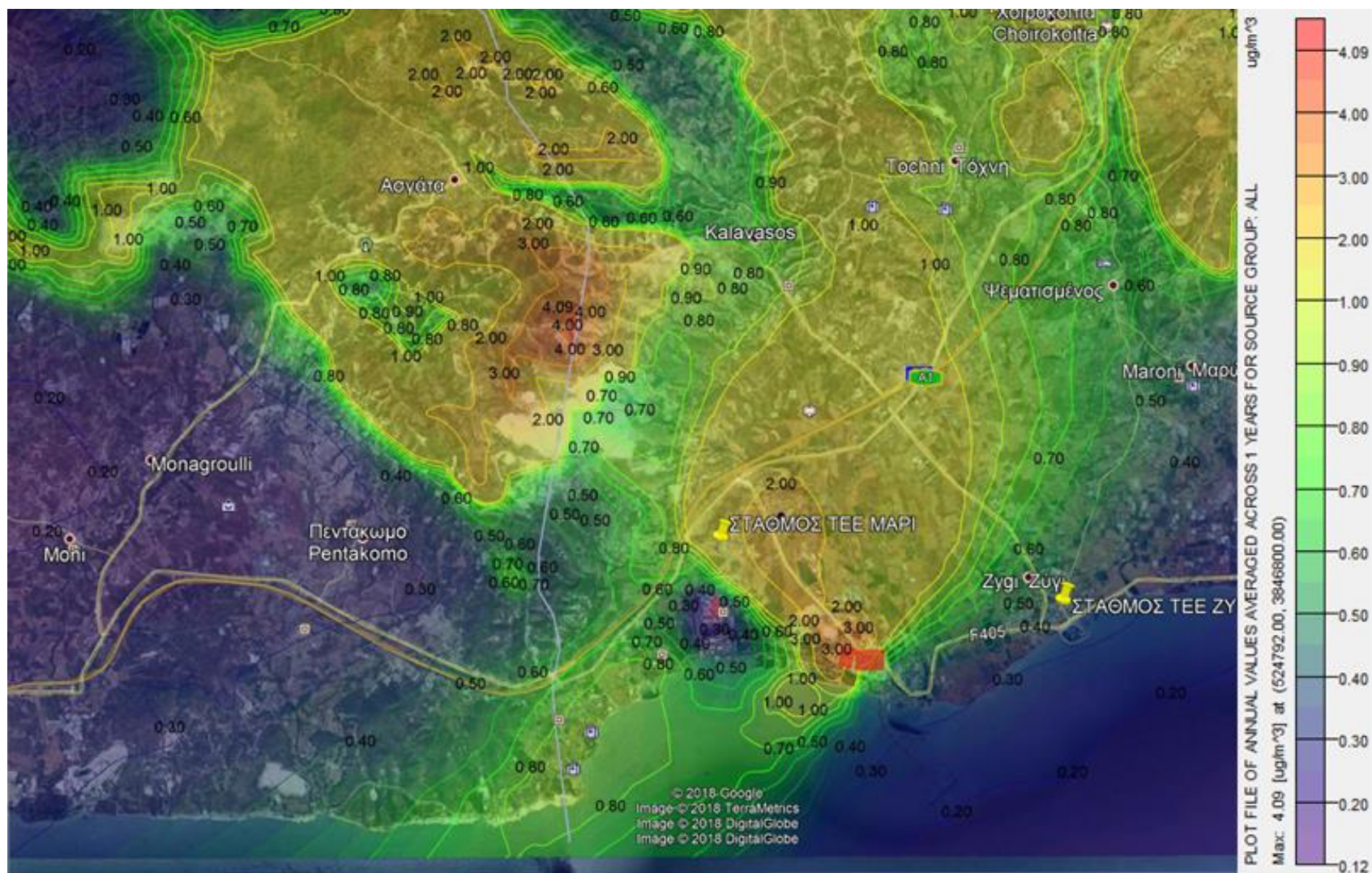
Εικόνα Γ.4: Μέση ετήσια συγκέντρωση SO 2 - υφιστάμενη κατάσταση (max. 4.1 µg/m 3 )
