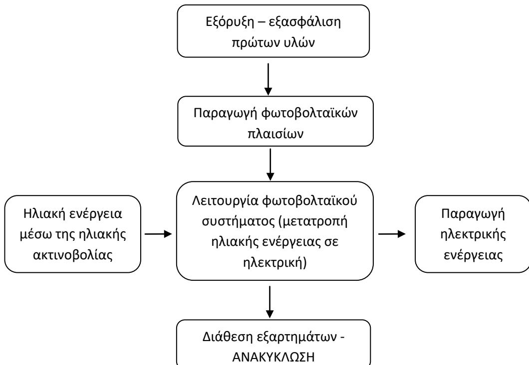
**Σχήμα 3.** Ανάλυση κύκλου ζωής ενός Φ/Β συστήματος
