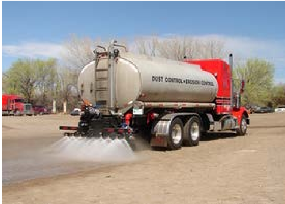
Εικόνα 7-2: Κατάβρεξη χωμάτινων οδών και περιοχή εργασίας
