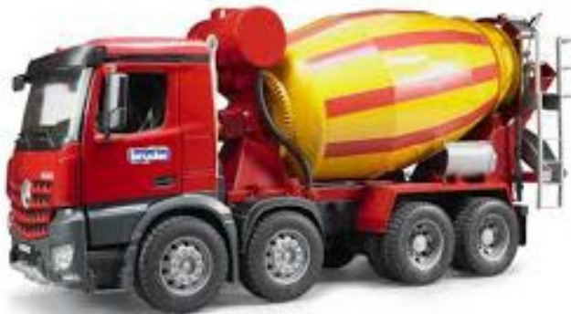
Εικόνα 5-6 :Μπετονιέρα -Concrete Mixer truck
