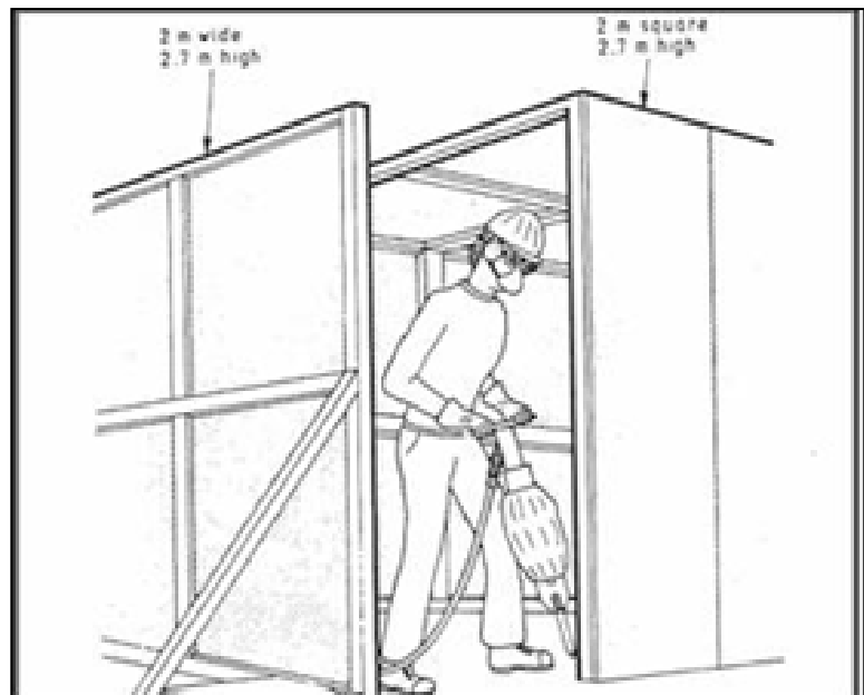
Εικόνα 7-4: Παράδειγμα ηχομονωτικού κουβούκλιου που αφορά μείωση θορύβου από μηχανήματα εργοταξίου
