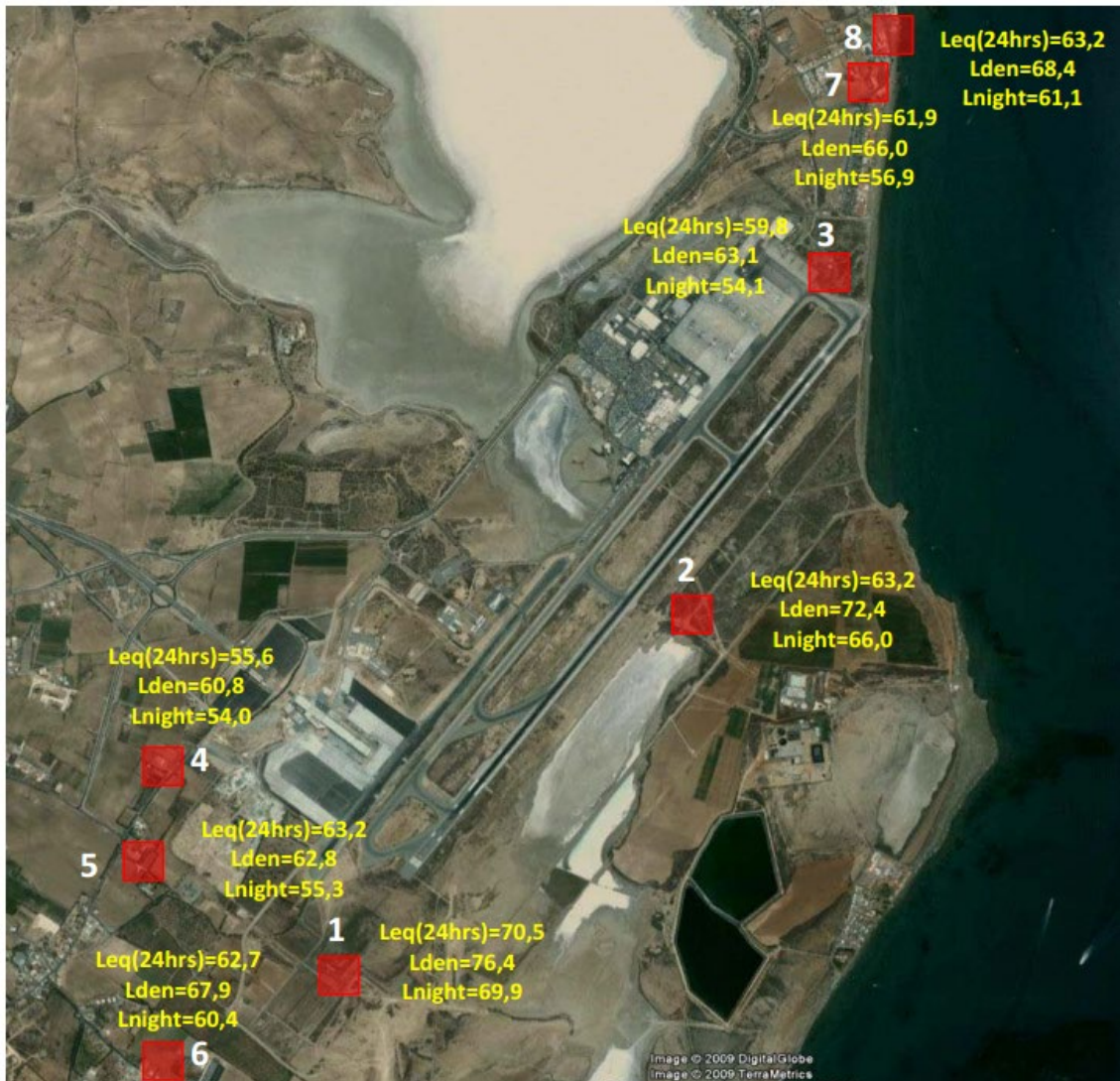
Εικόνα 6-2: Θέσεις 24ώρων ακουστικών μετρήσεων στο Αεροδρόμιο Λάρνακας
