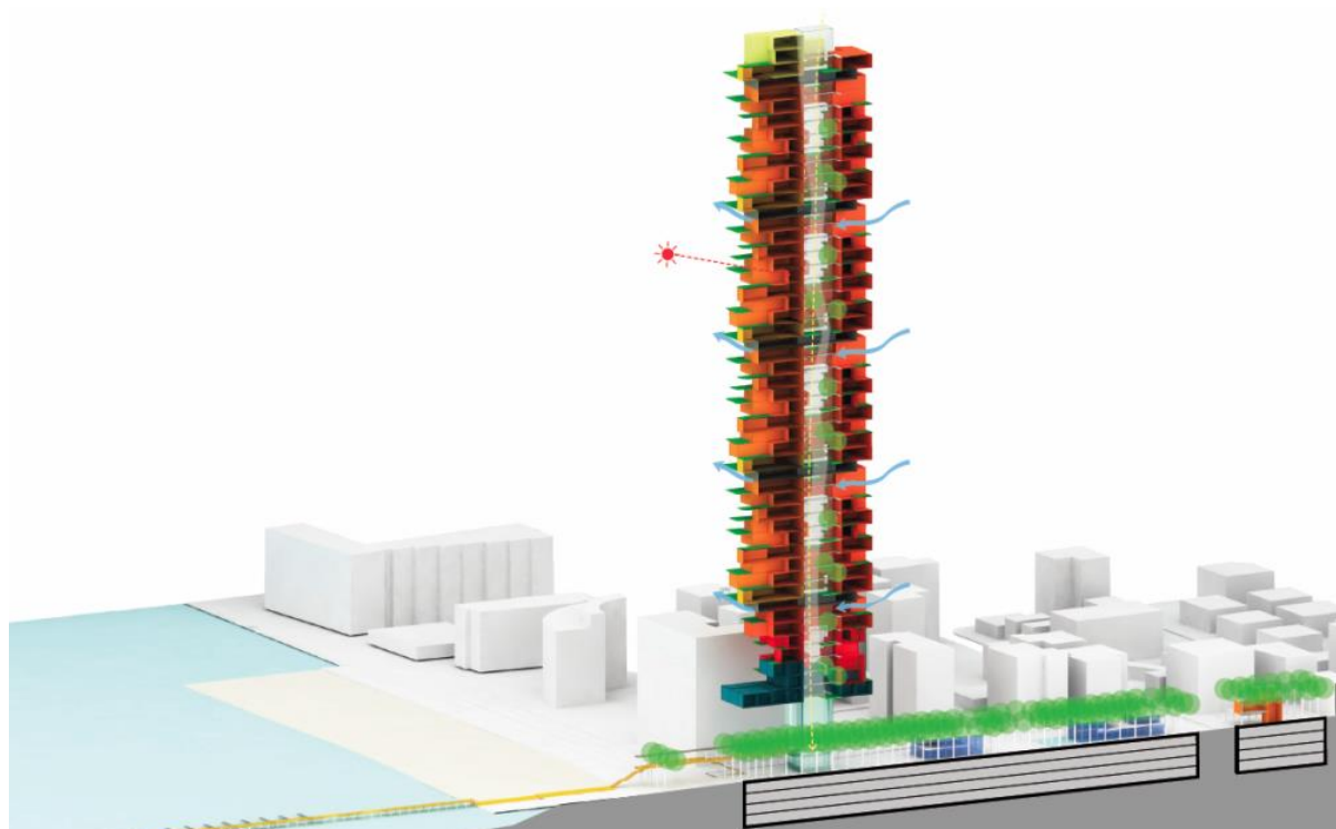
Διάγραμμα 6.4: Πλευρική όψη του προτεινόμενου κτηρίου με ενδείξεις διαδρομής αέρα (αερισμός και εξαερισμός) και έκθεση στο ηλιακό φως (το έντονο κόκκινο συμβολίζει τη μέγιστη έκθεση, ενώ το κίτρινο είναι η ελάχιστη έκθεση)
