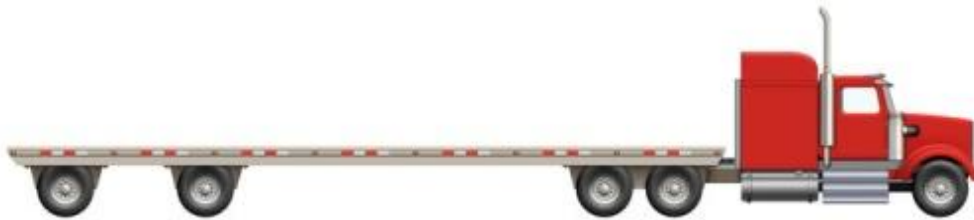
Εικόνα 6-9: Φορητό με τρέιλερ - Flatbed truck
