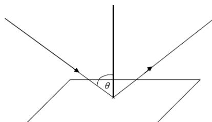
**Σχήμα 2.** Γωνία πρόσπτωσης σε οριζόντια επιφάνεια
