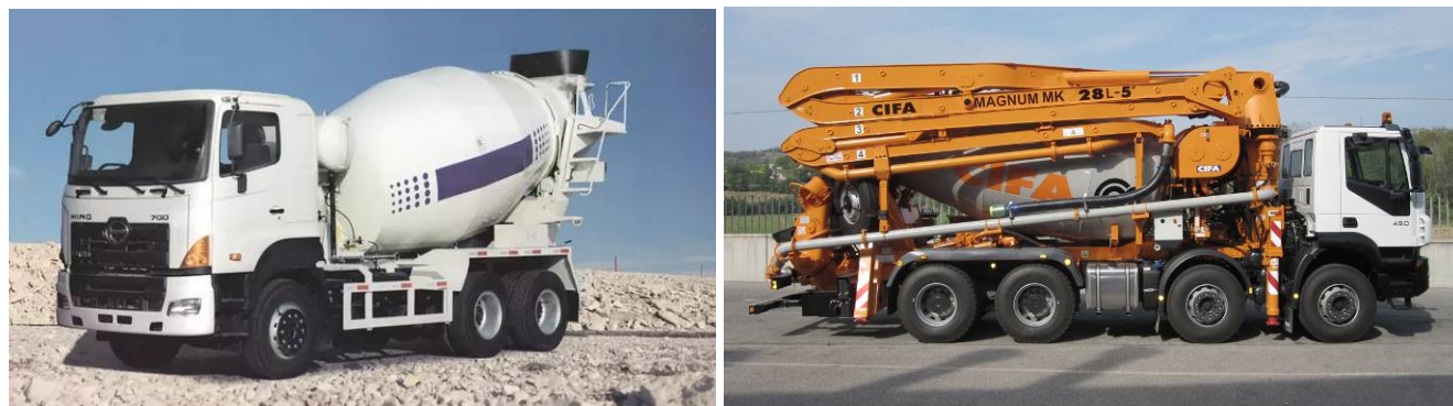
Εικόνα 6-5: Μπετονιέρα (αριστερά) και αντλία σκυροδέματος (δεξιά)
