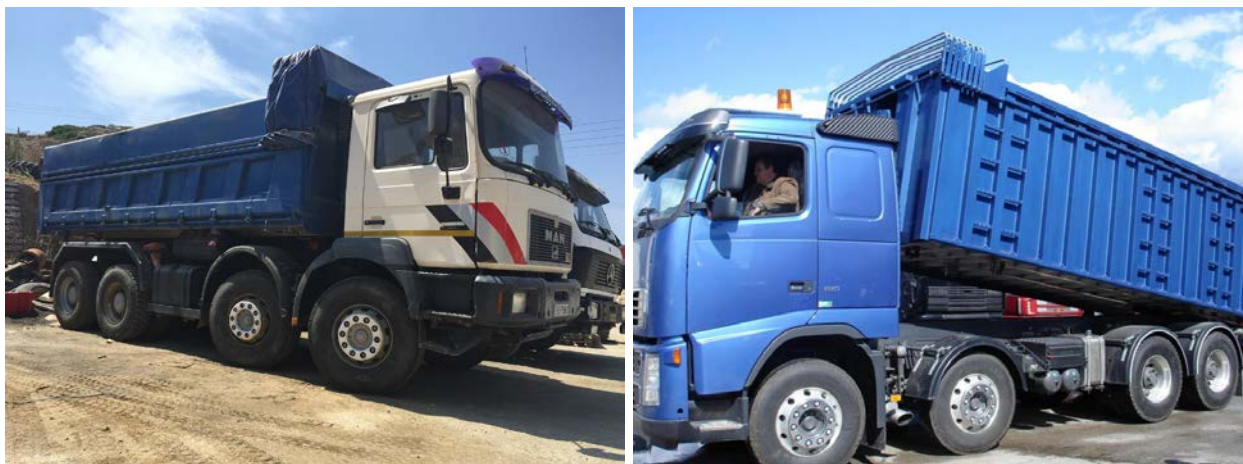
Εικόνα 6-3: Φορητά μεταφοράς αδρανών
