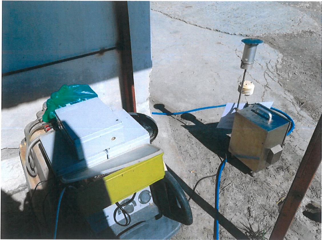
Φωτογραφία 1. Εξοπλισμός στο Σημείο Μέτρησης της αιωρούμενης σκόνης (2020)
