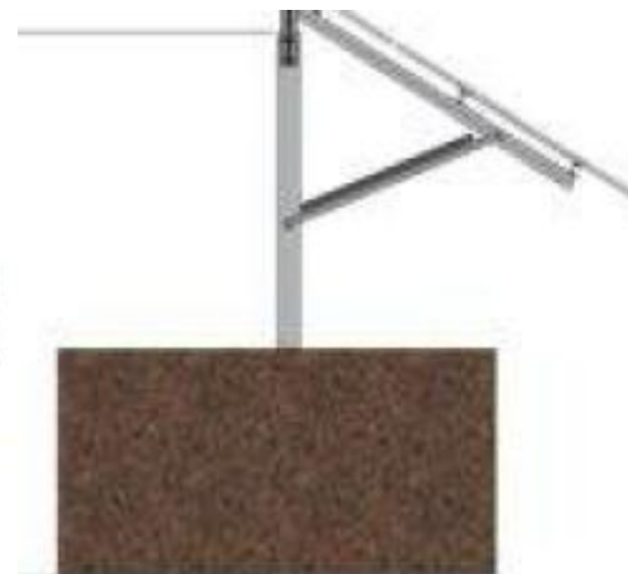
Εικόνα 6-12: Σχέδιο πασαλόμπτυξης Βάσης φωτοβολταϊκών πινάκων
