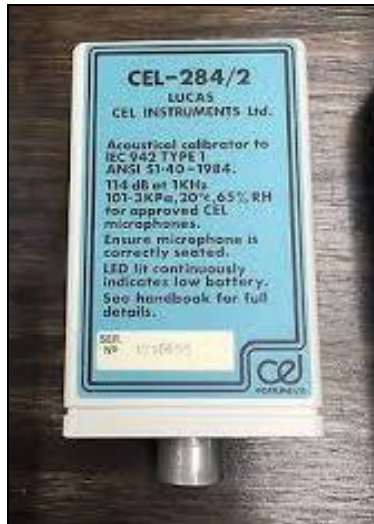
Εικόνα 7-4: Το όργανο βαθμονόμησης CEL-284/2 Acoustical Calibrator Class 1L
