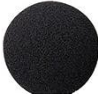
Εικόνα7-3: Windscreen WS-10 όπου χρησιμοποιήθηκε στο μετρητή θορύβου
