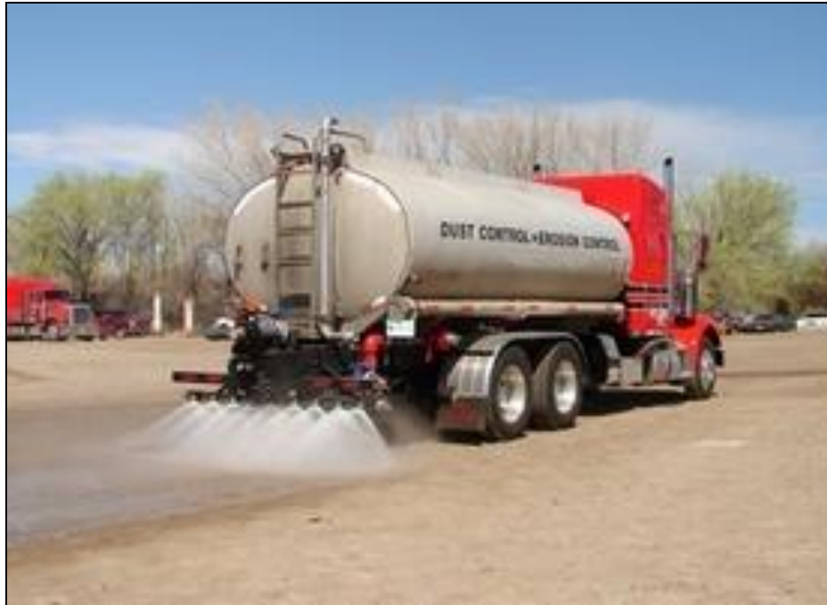
Εικόνα 9-1: Βυτιοφόρο όχημα με ψεκαστήρες για διαβροχή χωμάτων οδών
