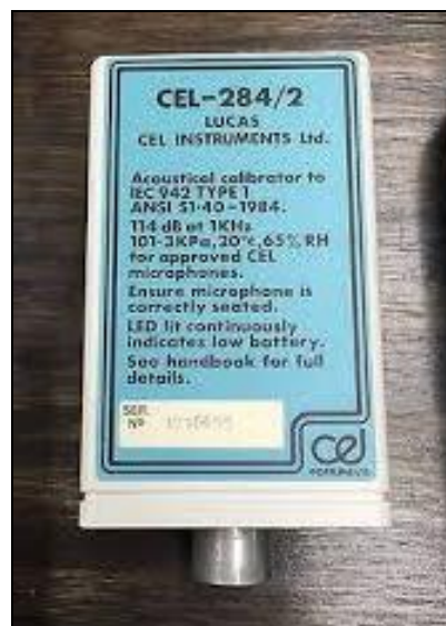
Εικόνα 7-3: Το όργανο βαθμονόμησης CEL-284/2 Acoustical Calibrator Class 1L
