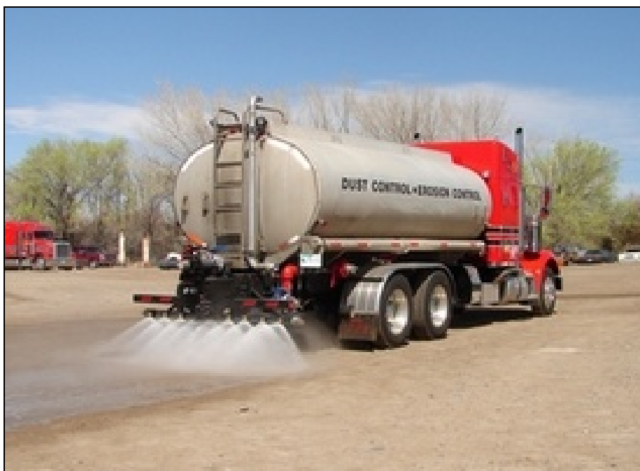
Εικόνα 9-1: Βυτιοφόρο όχημα με ψεκαστήρες για διαβροχή χωμάτινων οδών
