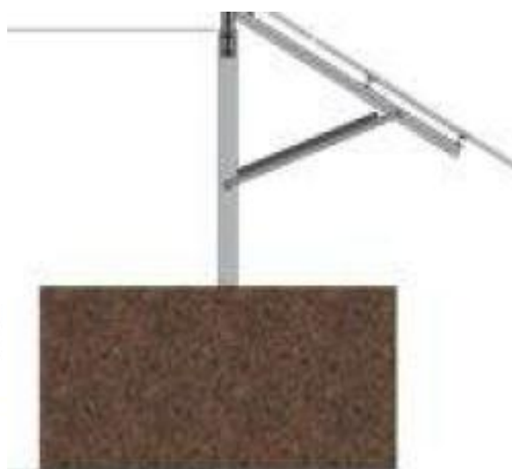
Εικόνα 6-7: Λεπτομέρεια Βάσης Φωτοβολταϊκών Πινάκων (πηγή : Profilodomi)
