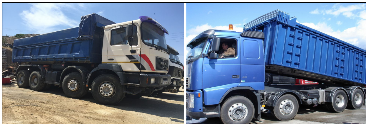
Εικόνα 6-4: Φορτηγά μεταφοράς αδρανών
