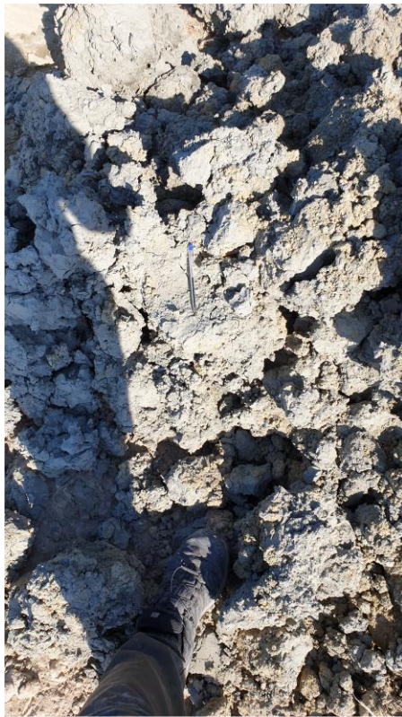
Φωτογραφία 9: Λιθολογικοί Ορίζοντες που προέκυψαν κατά την ανόρυξη της γεώτρησης άντλησης της 4 ης Δοκιμαστικής Άντλησης (αριστερά Μάργα και δεξιά Αργυλικές Αμμοίλες)
