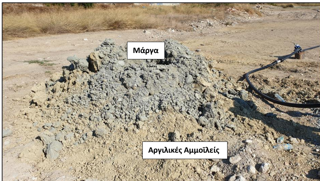
Φωτογραφία 6: Λιθολογικοί Ορίζοντες που προέκυψαν κατά την ανόρυξη της γεώτρησης άντλησης της 1 ης Δοκιμαστικής Άντλησης
