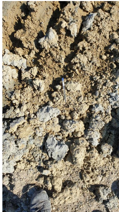
Φωτογραφία 9: Λιθολογικοί Ορίζοντες που προέκυψαν κατά την ανόρυξη της γεώτρησης άντλησης της 4 ης Δοκιμαστικής Άντλησης (αριστερά Μάργα και δεξιά Αργυλικές Αμμοίλες)
