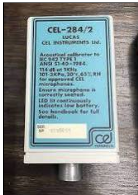
Εικόνα7-3: Όργανοβαθμονόμησης CEL-284/2 Acoustical Calibrator Class 1L
