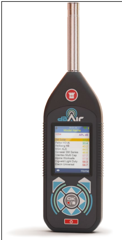
Εικόνα 7-1:Μετρητής dBAir Model GA 141
