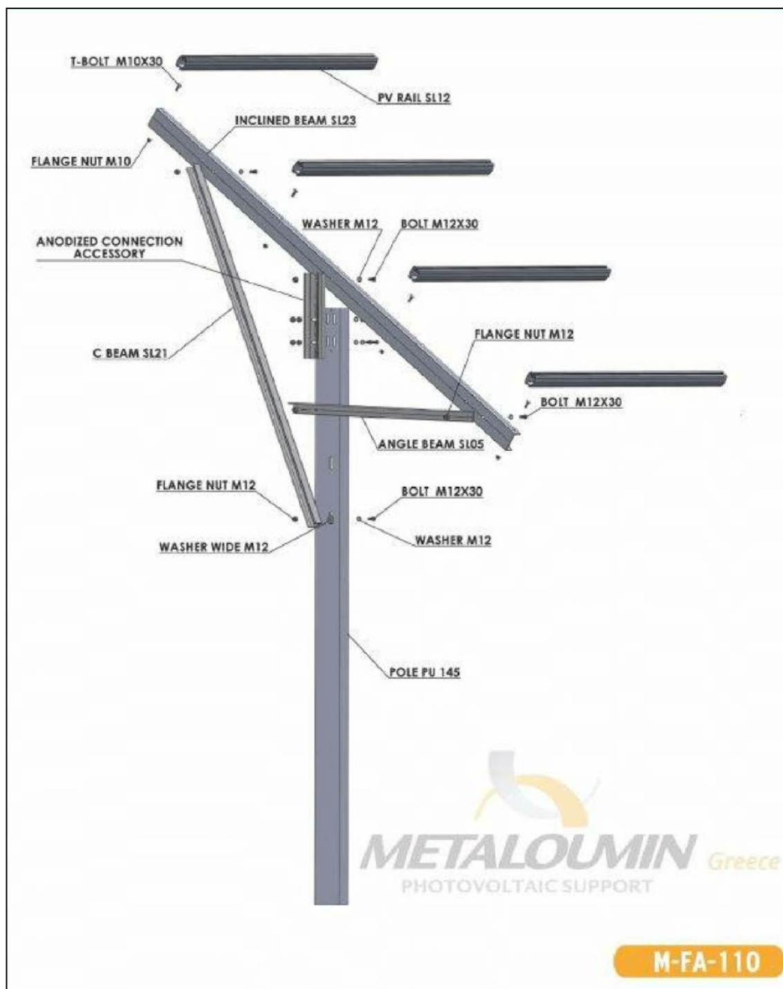
Εικόνα 6-8: Λεπτομέρεια Βάσης φωτοβολταϊκών πινάκων
