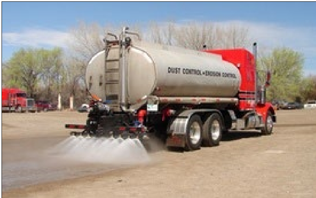
Εικόνα 9-1: Βυτιοφόρο όχημα με ψεκαστήρες για διαβροχή χωμάτων οδών
