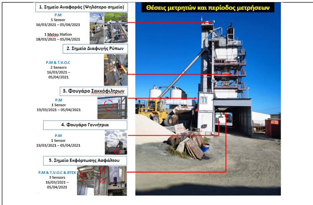
Εικόνα 2: Σημεία τοποθέτησης αισθητήρων στη μονάδα
