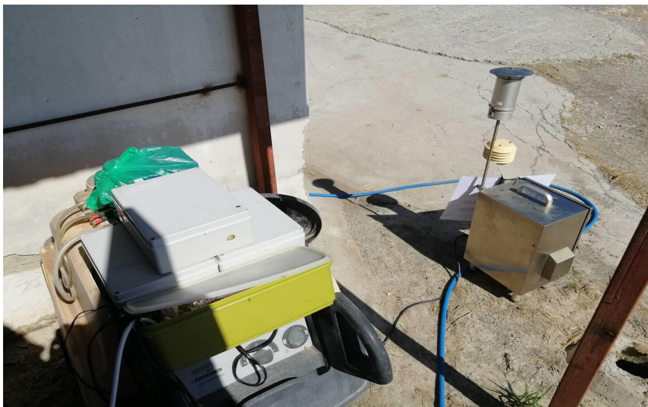
Φωτο 4-14: Εξοπλισμός στο Σημείο Μέτρησης της αιωρούμενης σκόνης (2020) (Αιολική Λτδ, 2021)
