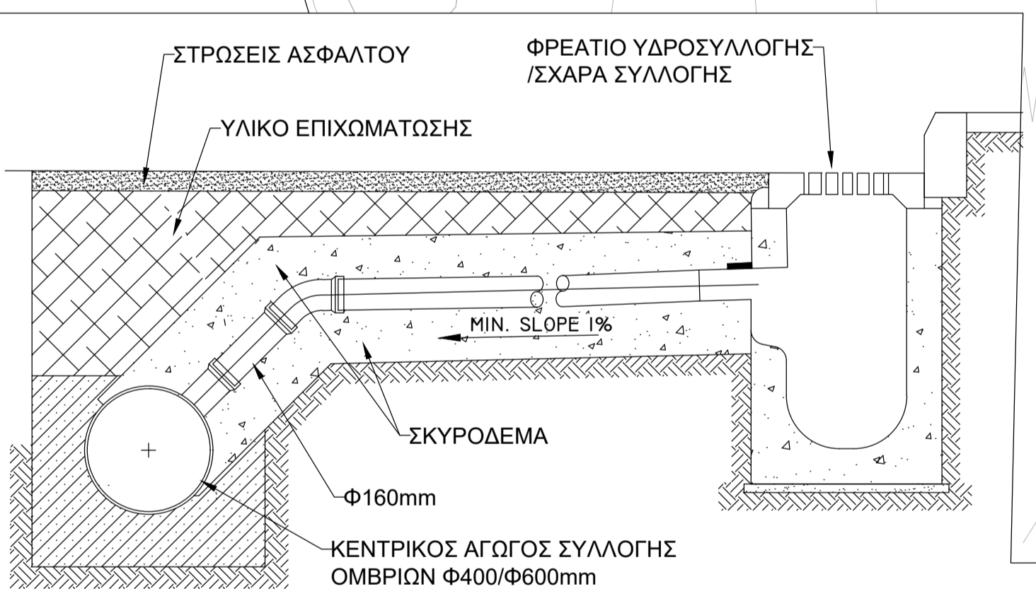
ΛΕΠΤΟΜΕΡΕΙΑ 1 ΤΥΠΙΚΗ ΤΟΜΗ ΚΕΝΤΡΙΚΟΥ ΑΓΩΓΟΥ ΟΜΒΡΙΩΝ ΚΑΙ ΦΡΕΑΤΙΟΥ ΥΔΡΟΣΥΛΛΟΓΗΣ
