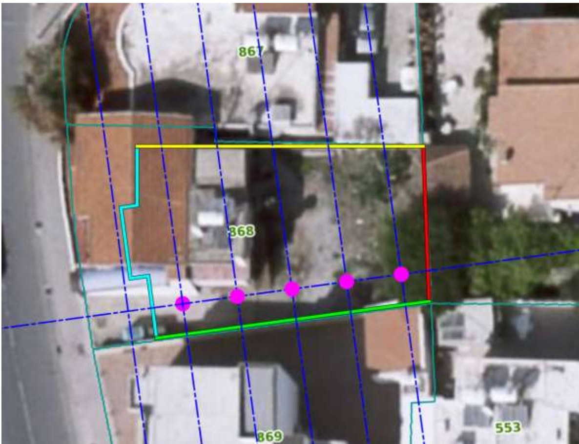
Εικόνα 3.29: Δορυφορική φωτογραφία με τη θέση των αντλιών σε σχέση με την εκσκαφή και τα όρια του τεμαχίου
