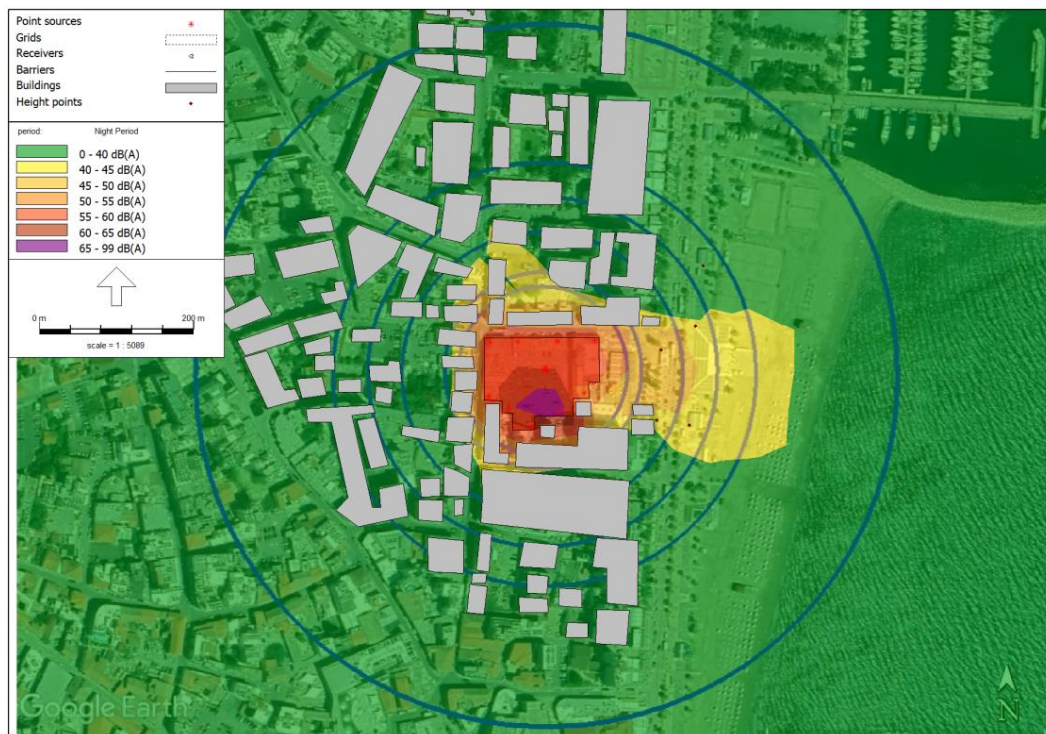
Εικόνα 6: Ισοϋψείς καμπύλες δείκτη θορύβου L_{night} (dB(A)), εργασίες εκσκαφής και αποστράγγισης φάση κατασκευής με την τοποθέτηση ηχοπετάσματος
