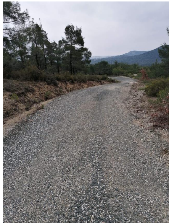
Σχήμα 6. Αδρανές υλικό σταθεροποίησης του οδοστρώματος χωματόδρομου στο Εθνικό Πάρκο Δάσους Δαδιάς-Λευκίμης-Σουφλίου, σε σχετικά επίπεδο έδαφος αριστερά και επικλινές έδαφος στη δεξιά φωτογραφία (φωτ. Φεβρουάριος 2021).
